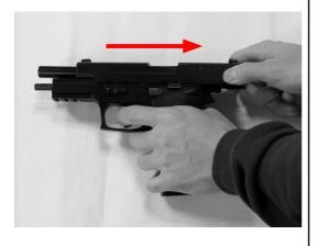
PULL THE SLIDE COMPLETELY TO THE REAR.
